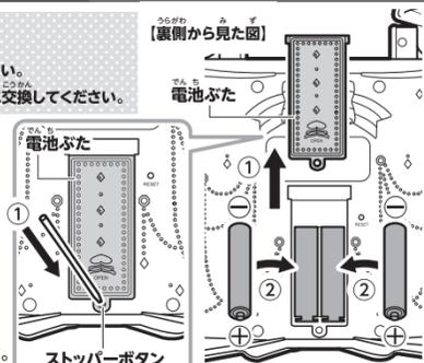
③電池ぶたを図のように本体の形状に合わせて置き、矢印の方向にスライドさせて元のよう閉じます。
